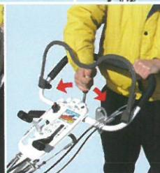
*Utilisez la machine en avant ou en arrière avec un seul levier.*
