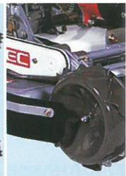
*Ce mécanisme débraye automatiquement lorsqu'une pierre se coince entre les roues et le chariot. La chaîne est ainsi protégée.*
