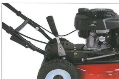
Réglage de la hauteur centralisé
